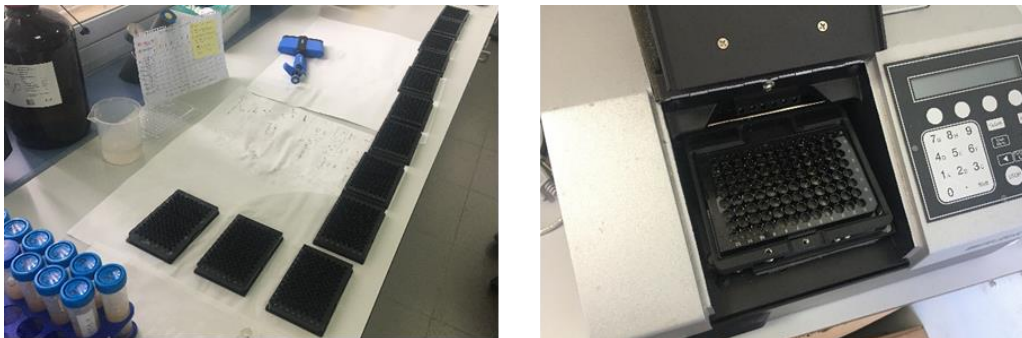
Figura 7. Proceso de adición de sustratos con fluorescente a las muestras de suelo con el fin de determinar la actividad enzimática (izqda.), y aparato empleado para la fluorimetría (drcha.).
