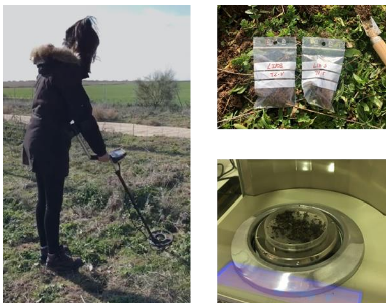
Figura 6. Imágenes del proceso de recogida y pesaje de las bolsas de té.
