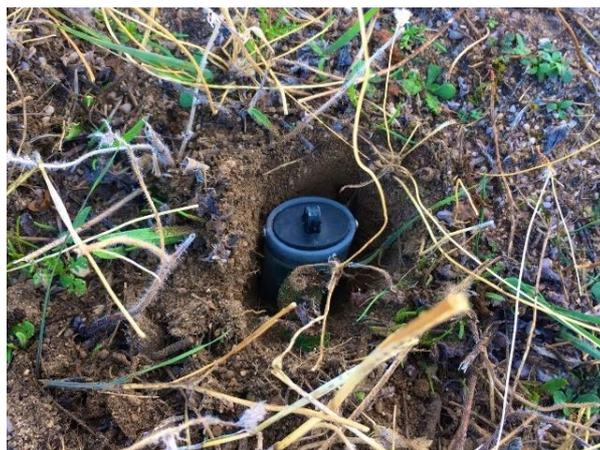
**Figura 2.** Medidor continuo de temperatura HOBO ubicado en el agujero en el suelo en el que permanecerá durante el periodo de duración del proyecto. La fotografía está tomada antes de completar el enterramiento del dispositivo, cuya parte superior quedará a ras de suelo.
